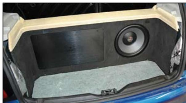
L'amplificateur et le sub sont maintenant montés. Comme Julio ne conçoit le travail que parfaitement terminé, il a ajouté une plaque de finition à l'avant et sur les côtés, ainsi qu'un bâti en bois soigneusement « formé » sur le dessus.
