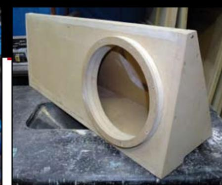
Ensuite, Julio a fabriqué un caisson très rigide, destiné à recevoir un seul subwoofer et à servir de support à l'amplificateur. Notez sa forme triangulaire, permettant son insertion parfaite dans le coffre, banquette arrière en place, tout en laissant un espace disponible devant.
