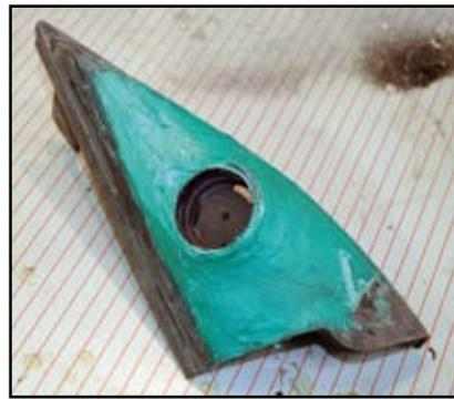
Parallèlement, les petits triangles supérieurs (dans les angles des vitres) sont également démontés puis « résinés » pour accepter les logements des tweeters. C'est peut-être par là que les débutants peuvent commencer, pour se faire la main !
