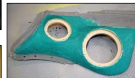
Ensuite, et toujours du côté intérieur (non visible de la contre-porte), de la résine permet de stabiliser et rigidifier le tout de manière parfaite
