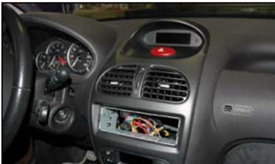
Passons maintenant à la source. Comme on le voit, l'autoradio d'origine était un modèle standard 1 DIN. Tout l'ensemble de la coque externe de la console centrale doit ensuite être retirée.
