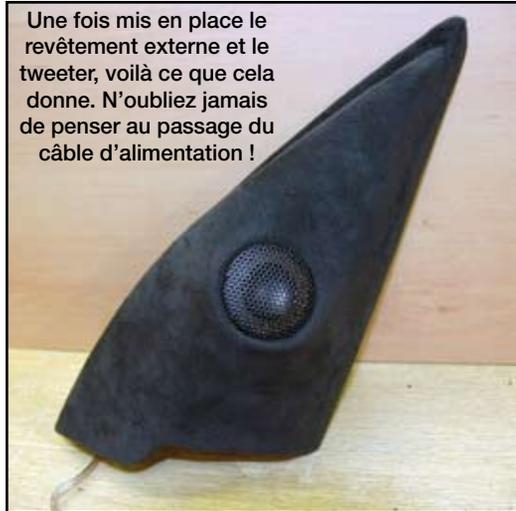
Et voilà tout l'ensemble remonté. C'est simple, sobre, efficace et très performant ! Notez au passage l'encastrement du filtre passif dans un des vide-poches, et qui devient finalement l'élément le plus visible de la transformation.
