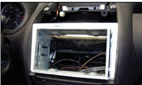
Plus difficile, par contre, est le traitement du tableau de bord. On ne le voit pas bien, mais il a fallu dégager l'espace nécessaire à l'autoradio double DIN, et prévoir une barre métallique horizontale pour que la fixation externe d'origine de l'autoradio prenne parfaitement appui. Ne négligez surtout pas cette étape.
